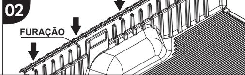
Posicione o protetor na caçamba do veículo e faça marcação conforme figura. Após, faça furação com broca Ø 9mm, transpassando a lataria.
