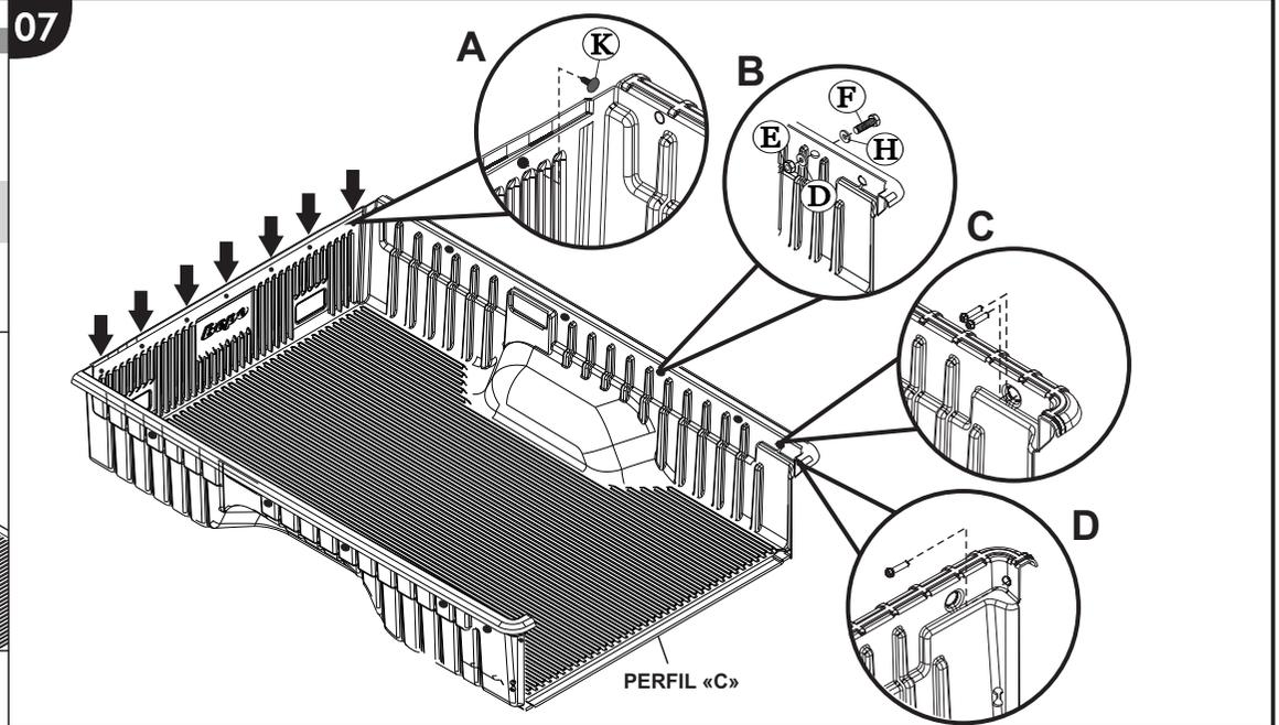
Monte os grampos de plástico «K» conforme ilustração «A».
