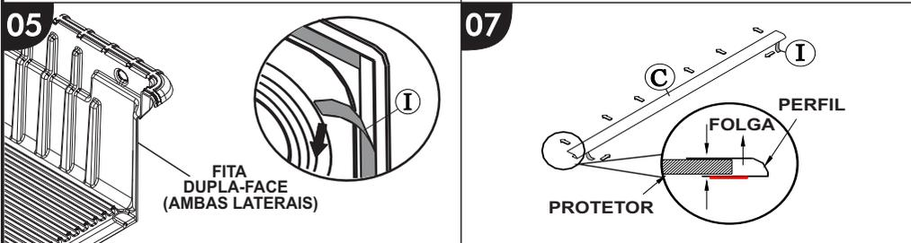
Retire a proteção da fita dupla-face «I» nas laterais do protetor da caçamba; é importante que a caçamba da pick-up esteja limpa, para uma melhor aderência da dupla-face.
