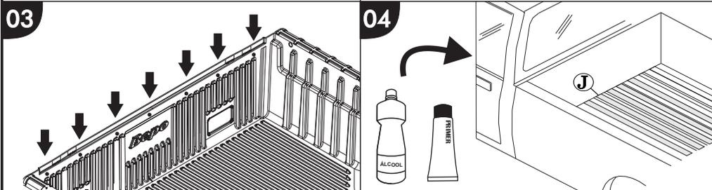
Faça a marcação no protetor distribuindo os 7 pontos indicados igualmente. Após, faça a furação transpassando a caçamba utilizando broca Ø6mm.
