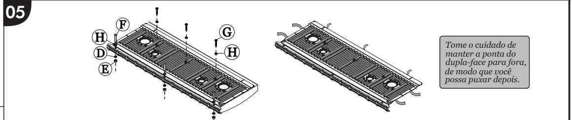
Fixe nos furos (passo 3), parafuso «G» e arruelas «H». Fixe nos furos (passo 4), parafusos «F», arruelas «H e D» e porcas «E». Faça pressão sobre a tampa até que a dupla-face pegue aderência.
