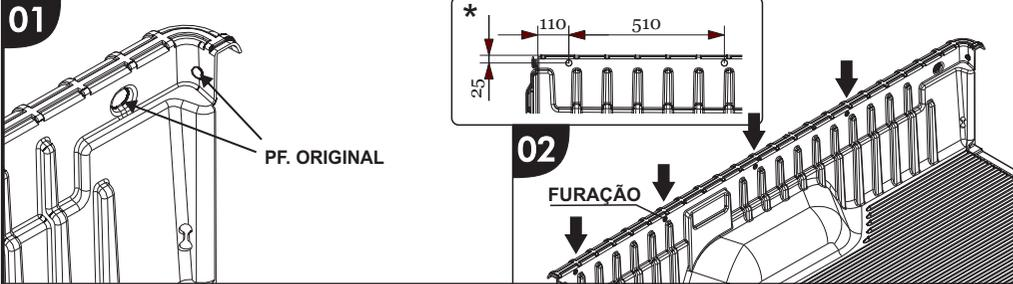
Retire os parafusos originais próximos a tampa do veículo. O furo próximo a tampa já está demarcado, faça a marcação centralizada para furar utilizando broca 9mm.
