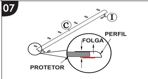
Encaixe o perfil «C» na parte inferior traseira do protetor e retire as pontas das fitas dupla-face «I», deixe um pedaço maior que os demais para fora.
