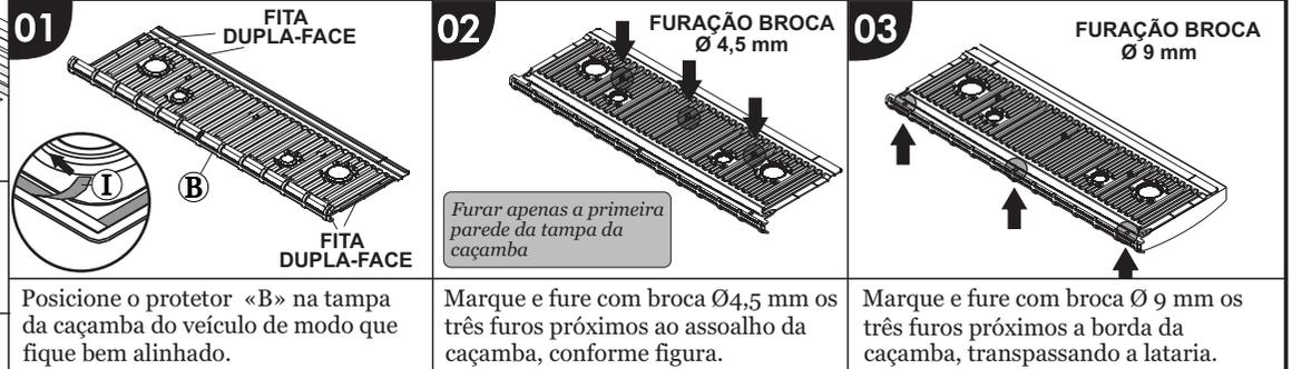
Posicione o protetor «B» na tampa da caçamba do veículo de modo que fique bem alinhado.
