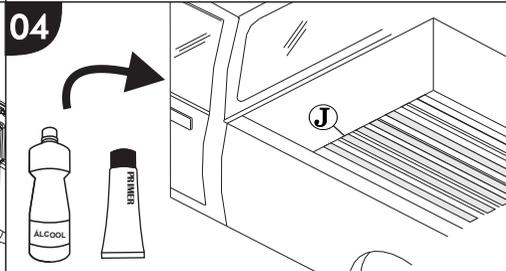
Limpe o interior da caçamba com álcool e depois aplique primer, antes de colocar o protetor; corte e distribua a fita spee «J» sobre a caçamba da pick-up.
